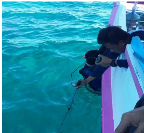
Gambar 11 Pengukuran arus insitu
